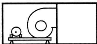
Si intende, per sbocco in plenum, un ventilatore che manda direttamente in un plenum, senza canalizzazione sulla bocca di mandata; per esempio, quando a valle della sezione ventilante viene installato un plenum di espansione per un silenziatore, un sezione multizona o un gruppo a tre serrande. In questo caso, si avrà una perdita di carico pari a 1.5 volte la pressione dinamica del ventilatore.
