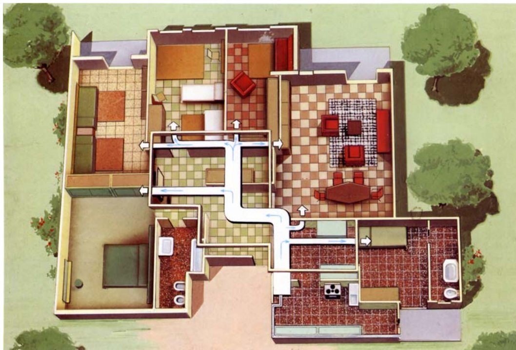
Riscaldamento di una villetta mediante l'impiego di un termoventilatore 3VB. L'unità è installata in un locale di servizio, e distribuisce l'aria calda mediante canali.
